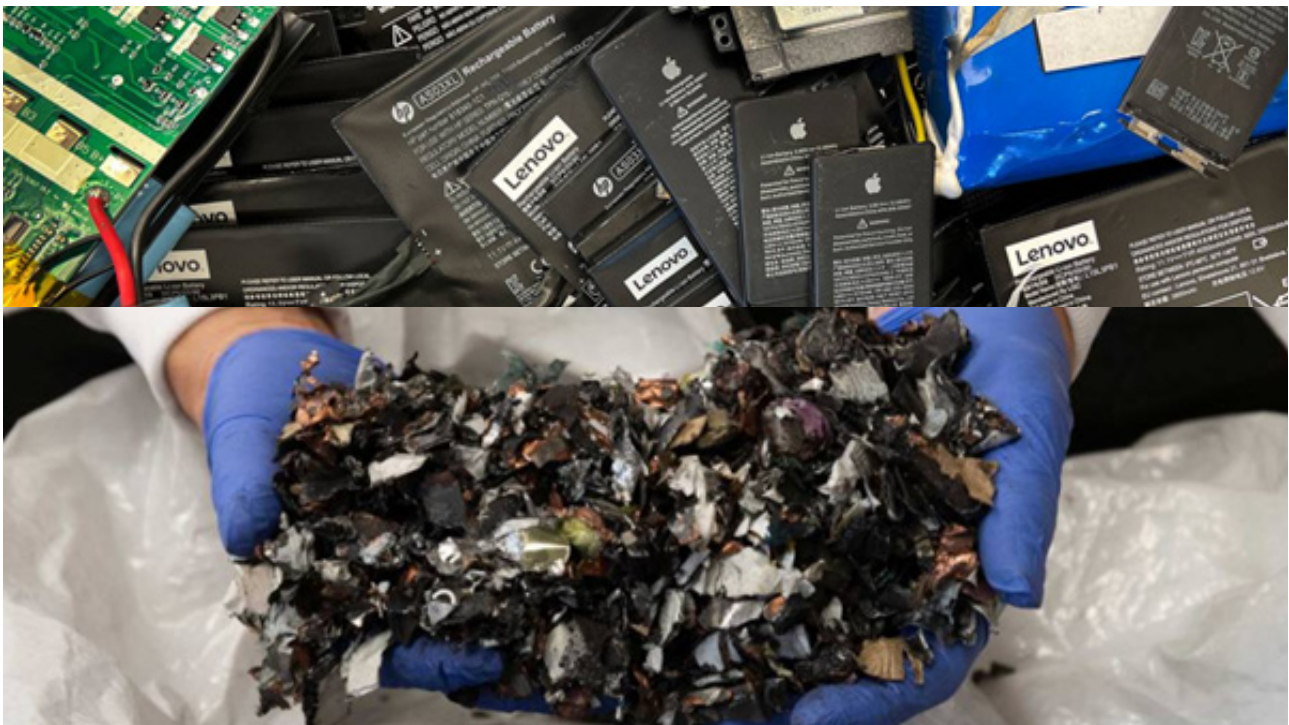
شکل ۸: ابعاد و تنوع و اشکال مختلف باتری، پیش‌تصفیه و بازیافت آن را دشوار می‌کند
